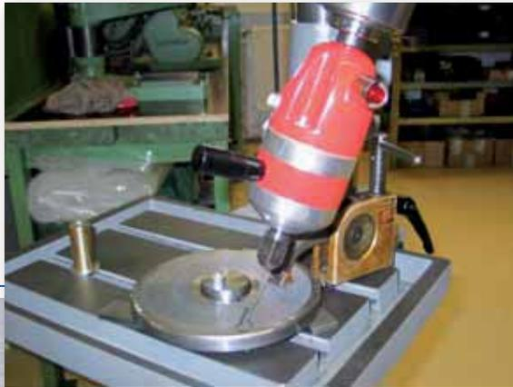
Erodieren von schrägen Bohrlöchern
