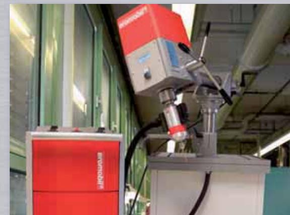
Erodieren in jeder Winkellage bzw. von großen Bauteilen auf der Radial-Erodierereinheit.
