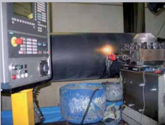
Erodieren an einer CNC-Drehmaschine. Die Vorschubregelung erfolgt manuell über das Handrad.
