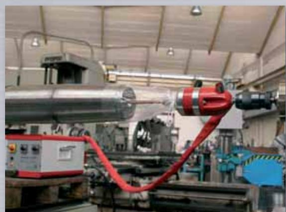
Horizontales Erodieren auf einem Bohrwerk. Anstelle des Bohrers wird der Schwingkopf des Erodiergerätes in die Maschine gespannt
