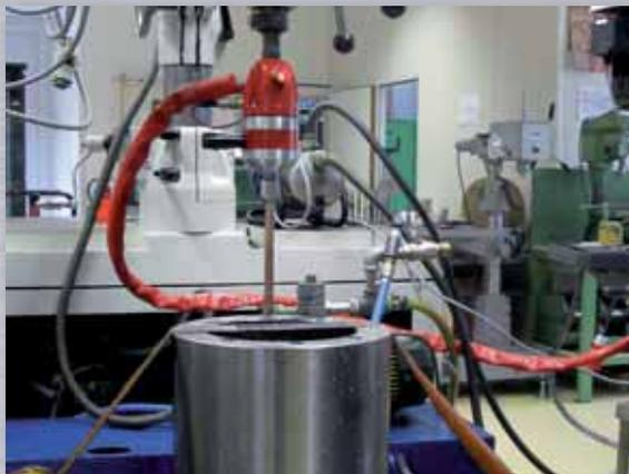
Abgebrochener Gewindebohrer in einem Kühlwassermantel, Erodieren mit automatischem Vorschub
