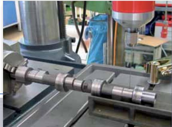
Erodieren einer Nockenwelle
