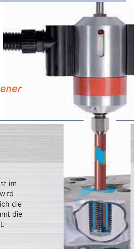
In den Schwingkopf wird die Kupfer-Hohlelektrode eingespannt. Diese ist im Durchmesser kleiner als das abgebrochene Werkzeug. Beim Erodieren wird das Kernstück des abgebrochenen Werkzeugs abgebaut. Dabei lösen sich die Schneiden und können leicht entfernt werden. Mit dem Werkstück kommt die Elektrode nicht in Berührung, dadurch bleibt das Gewinde unbeschädigt. Als Kühlflüssigkeit wird die im Betrieb übliche Bohremulsion verwendet
